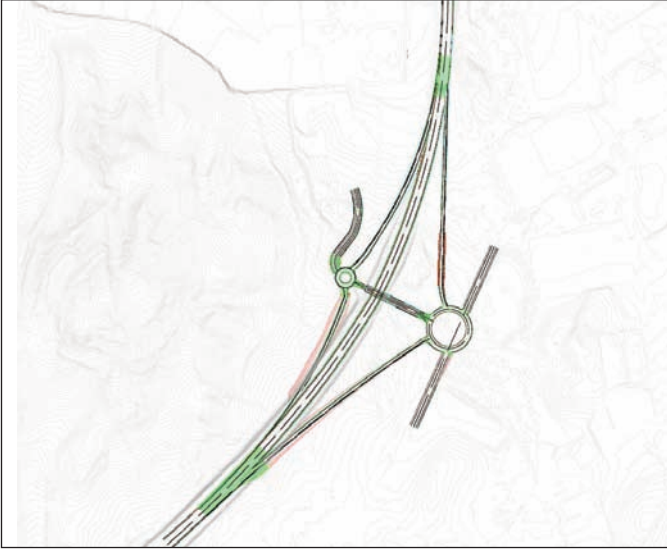
Planta del enlace generado con Istram
