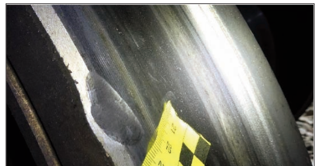
Muesca presente en la rueda derecha del eje 19 del tren de Iryo (coche 5, primera rueda, segundo bogie)
