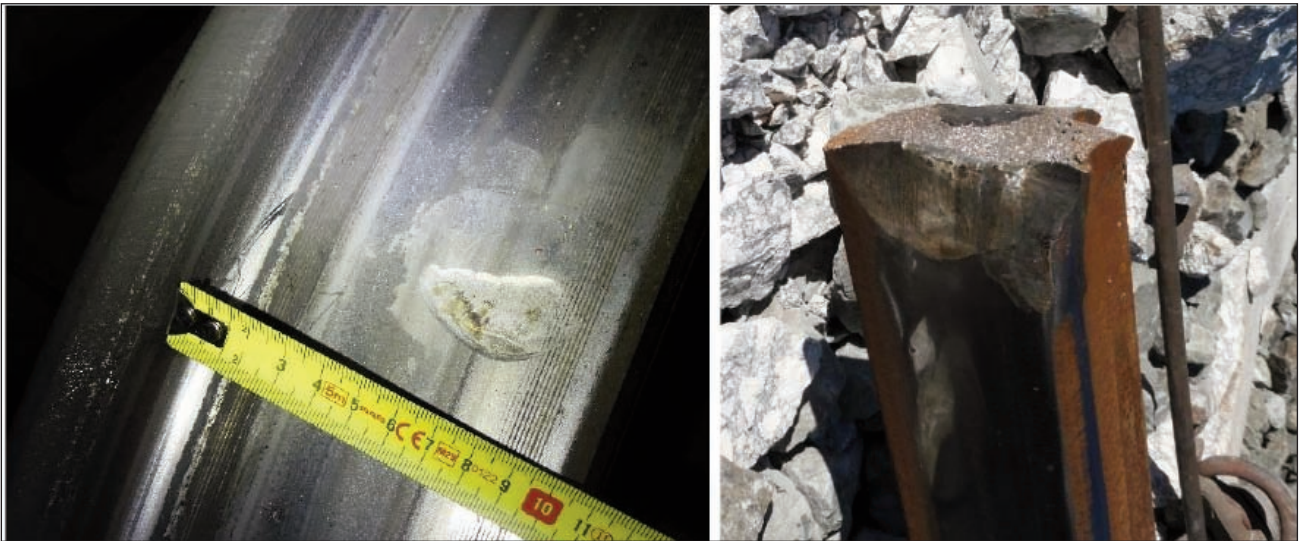
Muestras presentes en la rueda derecha del eje 13 del tren de Iryo (coche 4, primer eje del primer bogie) y posible punto de colisión con la cabeza del carril
